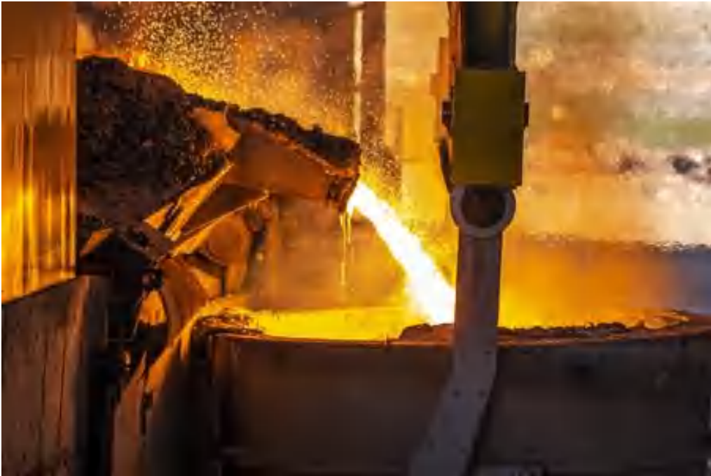
图22：浇铸前将熔化的金属转移到钢包中 27
